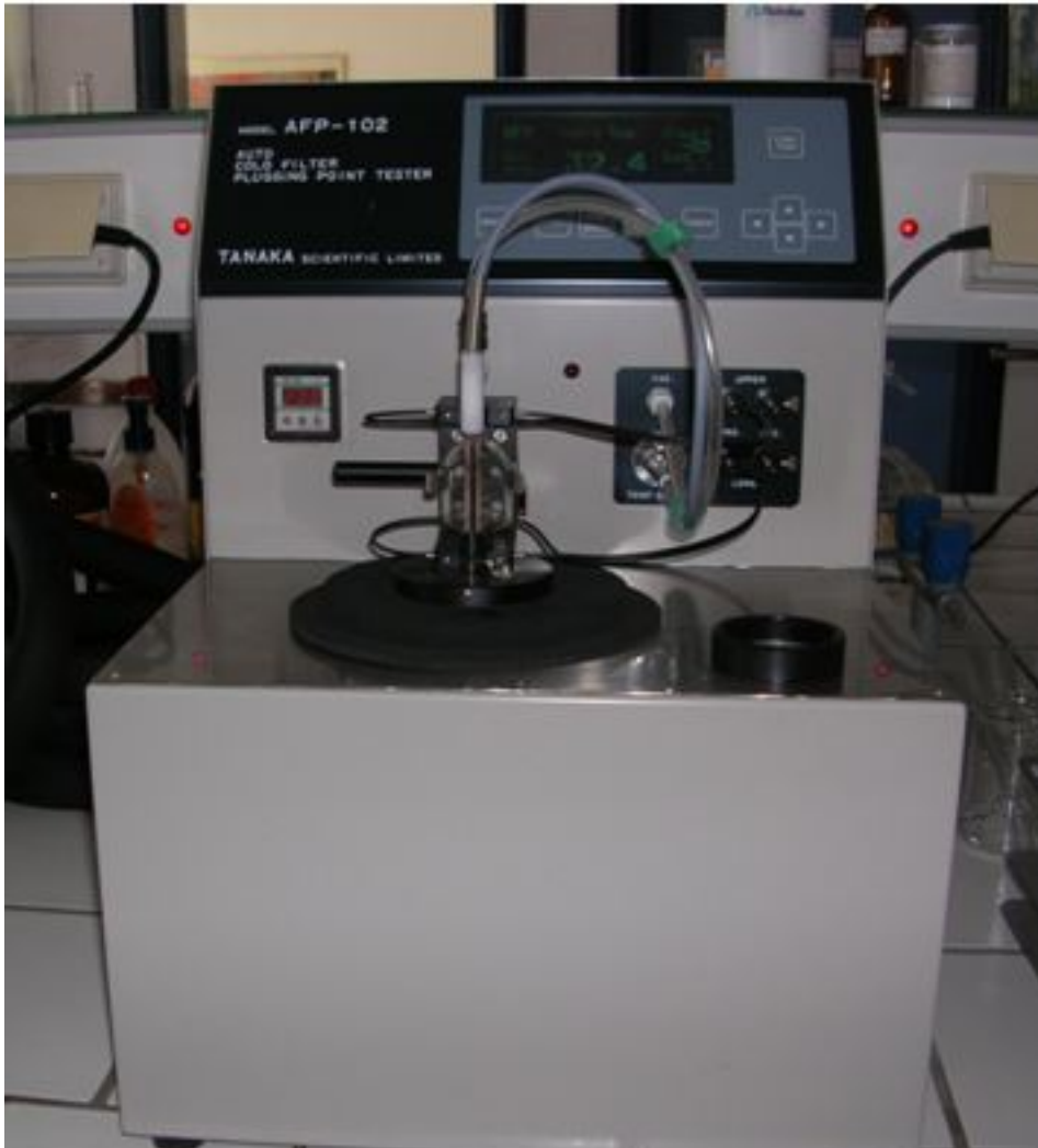
Εικόνα 4 (EN 116). Προσδιορισμός σπυρίων κοράνης μηχανή φίλτρου
