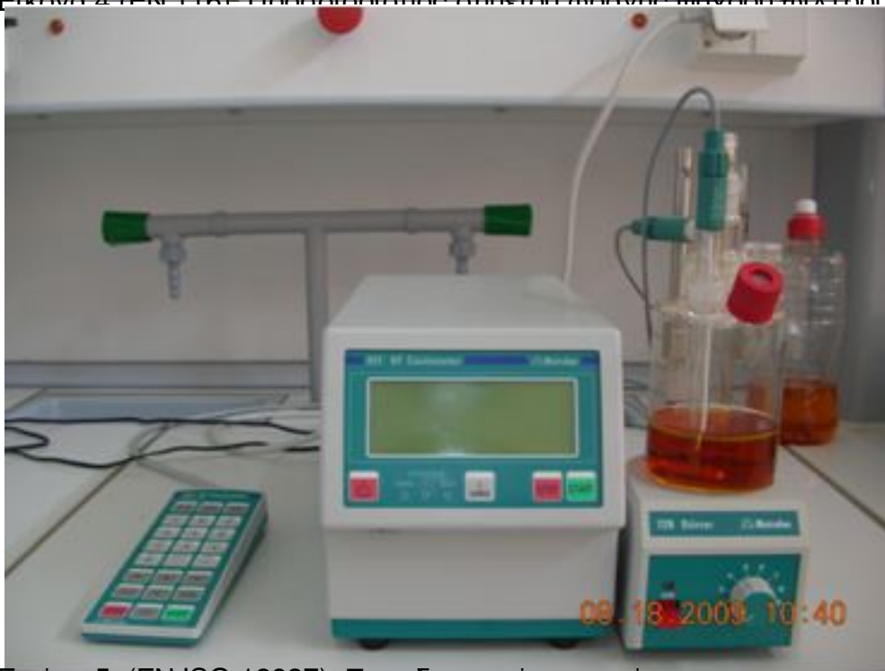
Εικόνα 5. (EN ISO 12937). Προσδιορισμός υγρασίας
