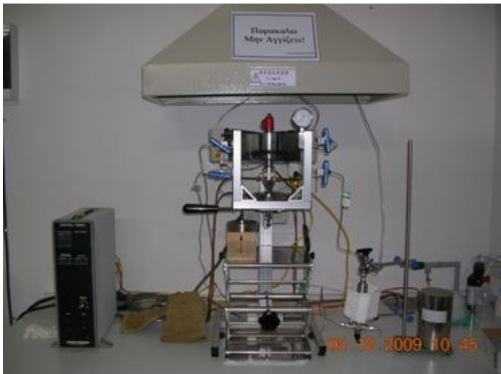
Εικόνα 6. Μονάδα αντιδραστήρα ασυνεχούς λειτουργίας (υδρογόνωση, υδροφορμυλίωση,
