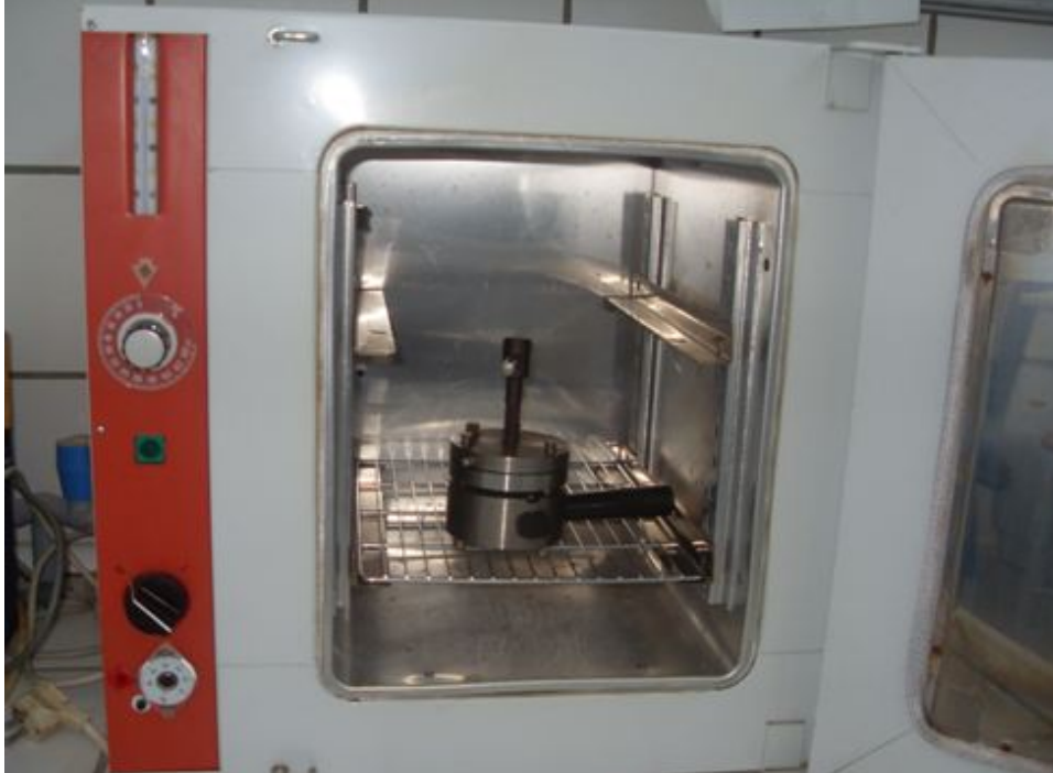
Εικόνα 2. Πρέσα μορφοποίησης θερμοσκληρυνόμενου σε φούρνο
