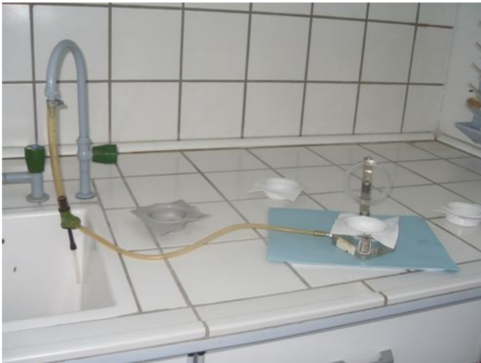
Εικόνα 1. Διάταξη μορφοποίησης θερμοπλαστικού με (υπο)πίεση
