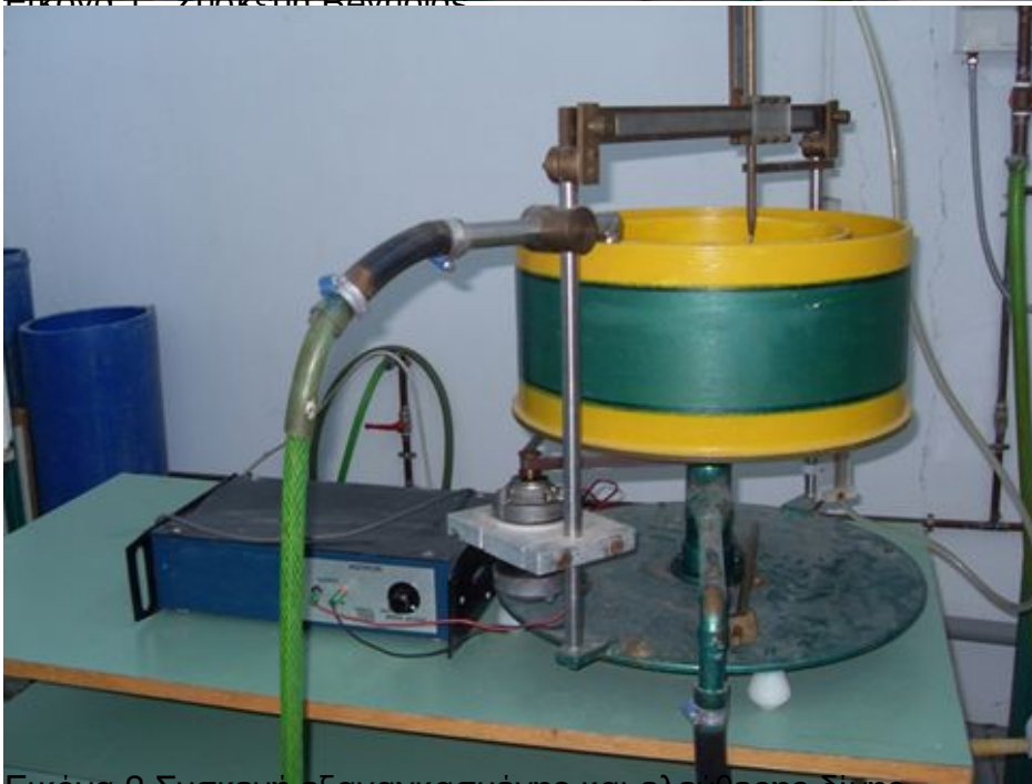
Εικόνα 2 Συσκευή εξαναγκασμένης και ελεύθερης οίνης
