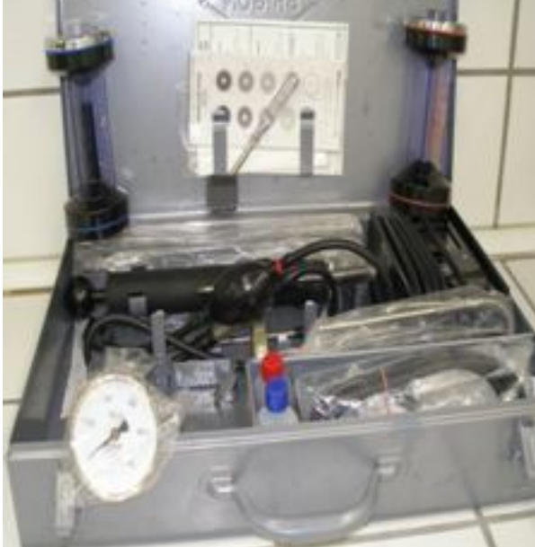
Εικόνα 2. Κυτίο προσδιορισμού βαθμού απόδοσης καυστήρα – λέβητα
